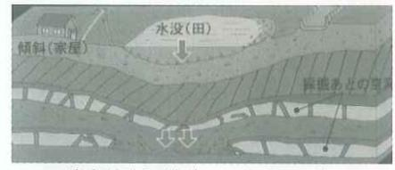
石炭採掘と鉱害のメカニズム
