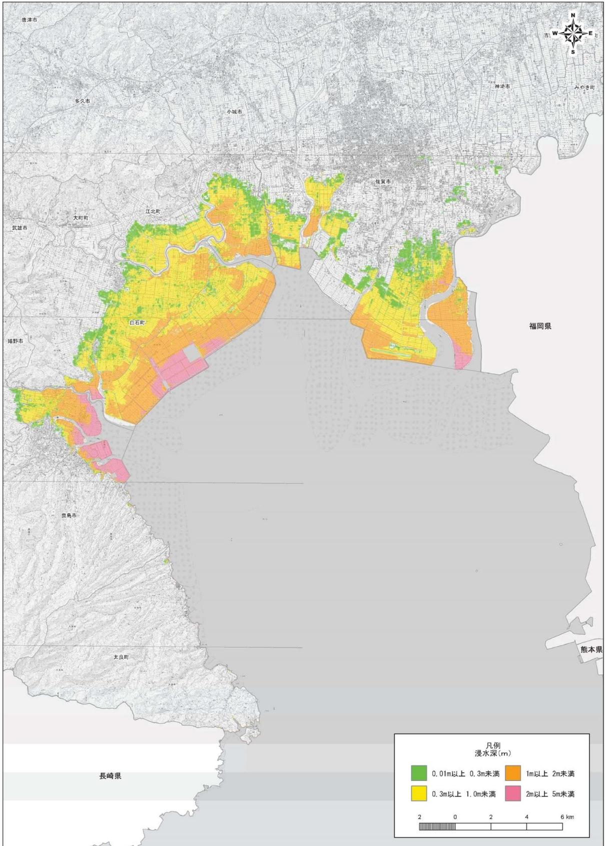
※ 有明海沿岸については、太良町の一部を除いて、海岸堤防からの直接の浸水箇所はほとんどなく、浸水箇所の多くは河川堤防の沈下による流入となっている。これは、「津波浸水想定の設定の手引き Ver. 2.00」による堤防沈下条件（耐震性の技術的評価がなされていなければ、地震発生後すぐに、震度等に関係なく一律に堤防高の75%が沈下する）に起因するものである。
