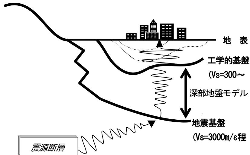
一方で、地震動は浅い軟弱な地層で著しく増幅されるが、そうした増幅の影響を受けない地下深部の基盤面を考えると、震源からの距離があまり違わなければ、基盤面に入射する波はどこでもほぼ同じと考えられる。この基盤を「地震基盤」と呼ぶ。具体的には、深さ十数kmまでの上部地殻のS波速度は毎秒3～3.5kmとほぼ一定であるため、地殻最上部のS波速度毎秒3kmの地層を地震基盤と呼んでいる。
