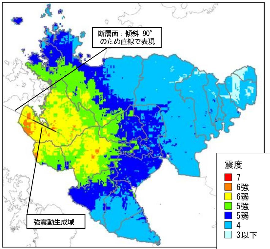
《各断層（帯）による地震で予測される地表計測震度の最大値による地域区分》
